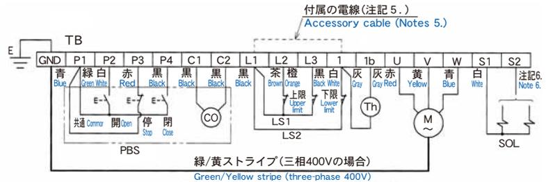
※三相400Vの場合は、モータ線(緑/黄ストライプ)とGNDを接続してください。
